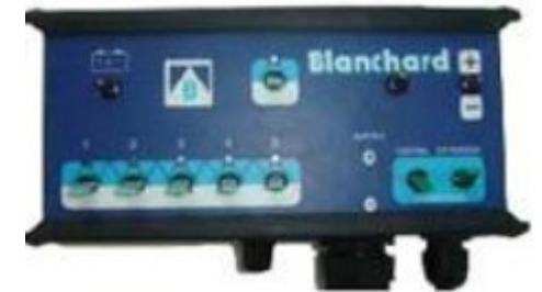
Boîtier de gestion de rampe de pulvérisateur Blanchard
